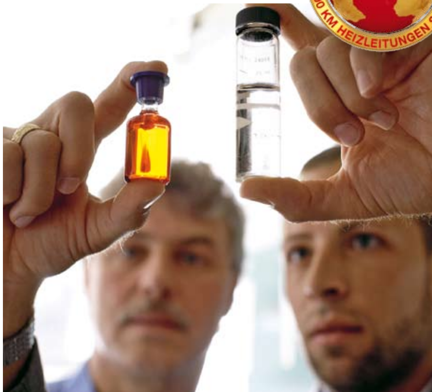
Wasserprobe vor Ort: Ein zu hoher Sauerstoffgehalt weist auf Versprödungen hin.
